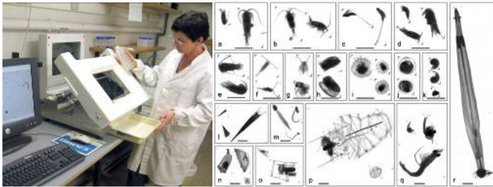
Figure 1: Gauche : récupération d'échantillon à partir du ZooScan après la numérisation, droite : image au ZooScan de zooplancton méditerranéen.
